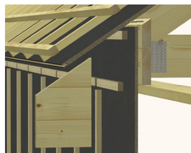
Overgang væg/tag med løs spærrende
