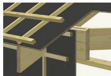
Seinän ja katon liitos, räystäälle jatkuvat yläpaarteet
