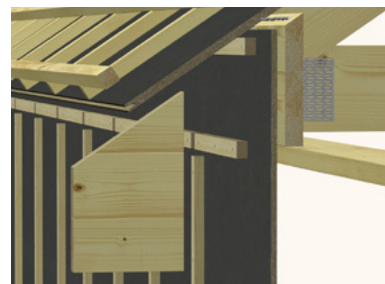
Seinän ja katon liitos, erilliset aluspuut
