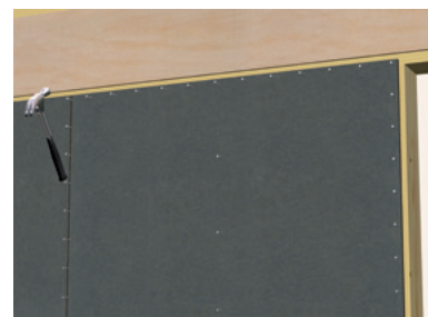
Naulausvälit: Reunoilla 100 mm:n välein ja keskellä 250 mm:n välein. Levyjen väliin rako 2-3 mm, elämisvara.
