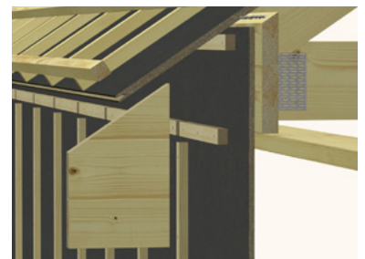
Seinän ja katon liitos, erilliset aluspuut
