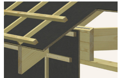
Seinän ja katon liitos, räystäälle jatkuvat yläpaarteet
